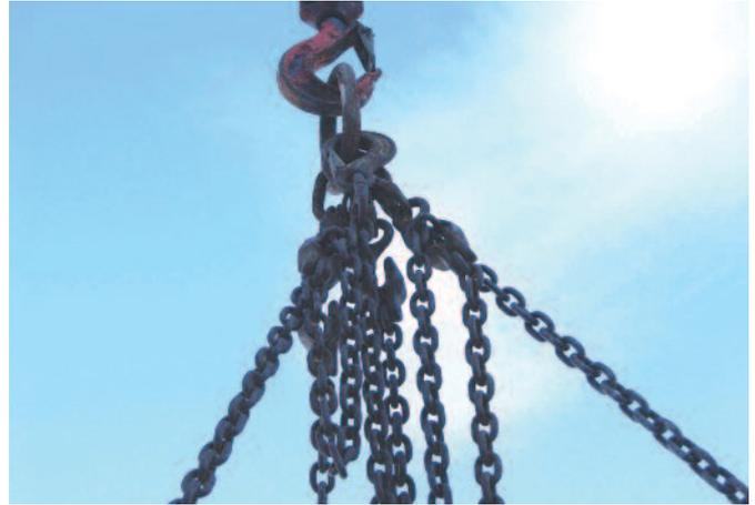
Bild 7: Ketten bzw. Seilgehänge immer auf Zug führen
