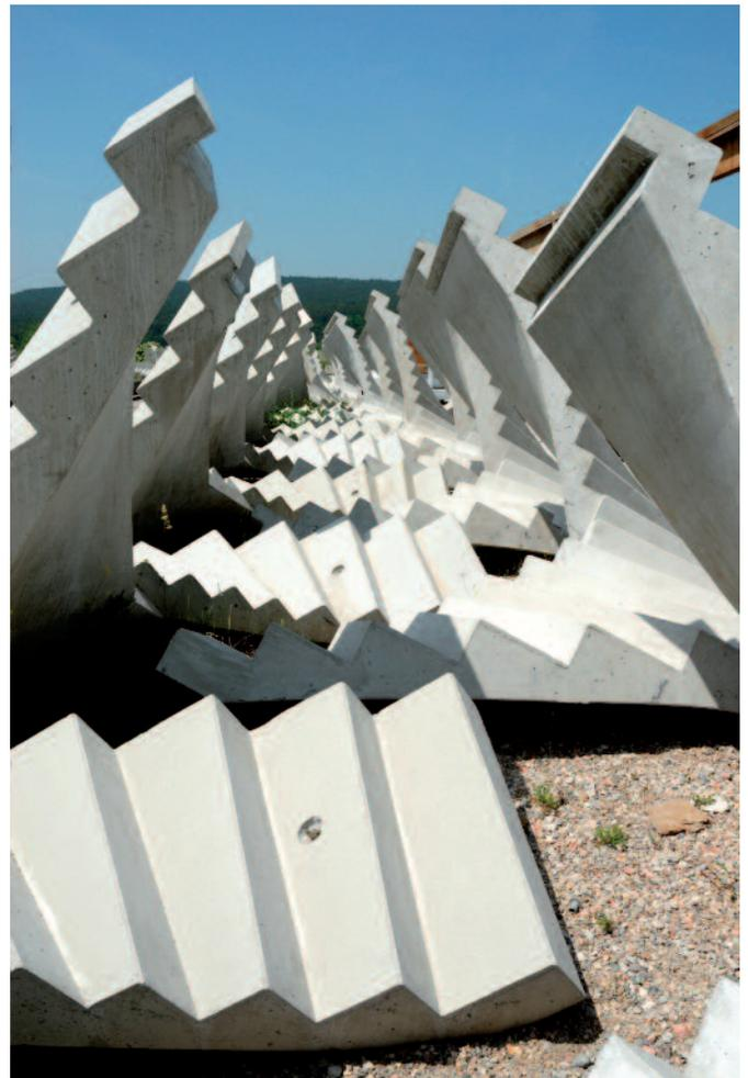
Bild 17: Gewendelte Beton-Fertigteiltreppen
