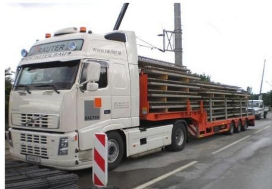
Die gelieferten Teile werden entweder sofort montiert oder möglichst im Schwenkbereich des Krans gelagert. Erfolgt die Lieferung im Innenlader, so wird die ganze Palette auf der Baustelle abgestellt. Der Untergrund muß ausreichend Tragfähig sein. Die Teile müssen möglichst so gelagert werden, daß es dadurch zu keinen Behinderungen auf der Baustelle kommt.
