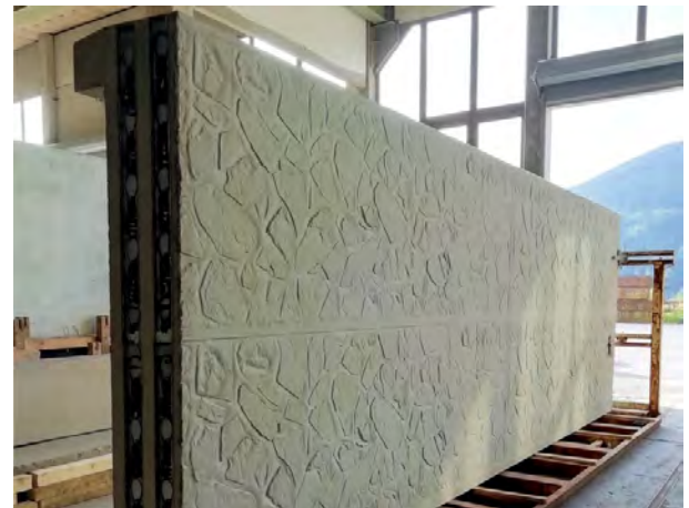
Anlieferung der massiven Sonderfertigteile und Installation der 28 Tonnen schweren Stützen sowie der Wandelemente für die neue Steinschlag-Verbauung an der „Steinerne Jungfrau“ genannten Felswand entlang der L127 Radmerstraße (Steiermark, Bezirk Leoben). Abdruck honorarfrei bei Nennung: © Kirchdorfer
